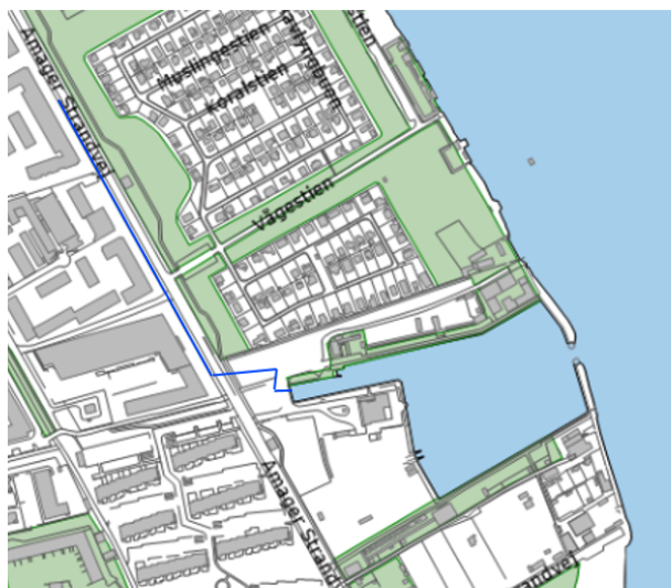
Regnvandsledning og udledningspunkt til Sundby Havn
